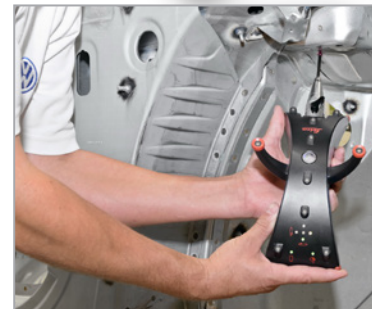
Беспроводное измерение скрытых точек
